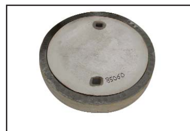
Tapa de fundición / hormigón: En caso de ubicarse bajo el paso de vehículos se deben instalar cubiertas de clase B125 o C250. Para lo que también es necesario añadir una losa de reparto de las cargas.
