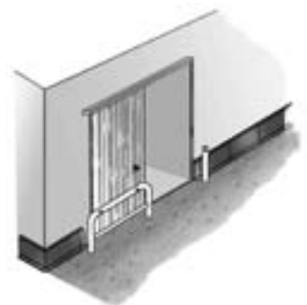
Protección de una puerta corredera con 1 poste y 1 barrera. La longitud de la barrera corresponde a la longitud de la puerta corredera. Proteger uma porta de correr com 1 poste e 1 barreira. O comprimento da barreira corresponde ao comprimento da porta de correr.
