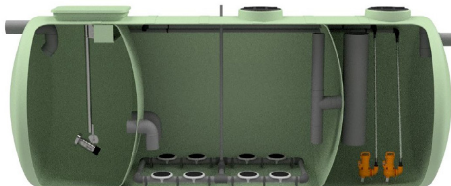
Reactor anóxico Reator anóxico
