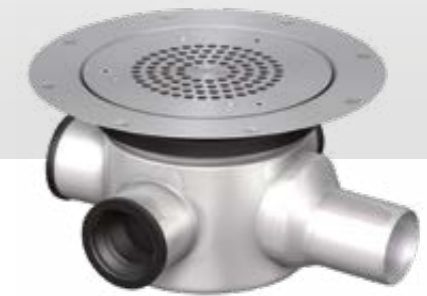
Arqueta con sumidero sifónico Câmara de Visita com sumidouro sifónico EG150x150mm DN50 (3 entradas) Salida Horizontal Saída Horizontal
