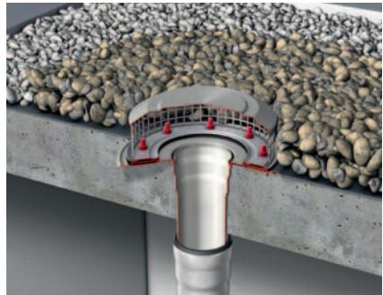
Sumidero de cubierta de acero inoxidable con brida para clipaje por compresión · Sumidouro de cobertura de aço inoxidável com flange para clipagem por compressão
