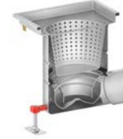
EG con Cestillo Extendido Fijo com Cesto Estendido Fijo 300x300mm DN110 Salida Horizontal Saída Horizontal
