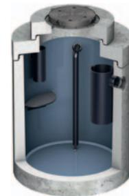
Separador de grasas LIPUMAX con aspiración directa de PEAD La conexión del tubo de aspiración se encuentra a 60° de la entrada izquierda.
