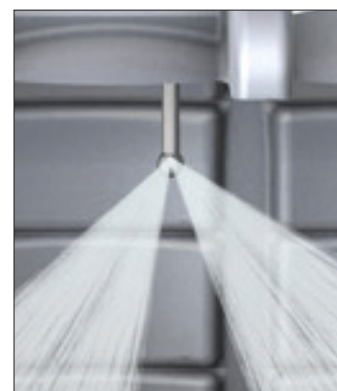
4. Funcionamento da cabeça de pulverização a alta pressão
